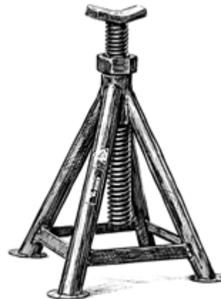
Exempel 2 – gängjusterat pallbock: Om pallbocken har gängjustering ska låsmutter användas.
